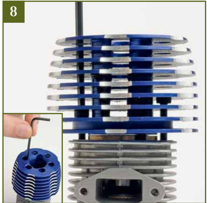
8 Prüfen Sie noch einmal, ob der Zylinderkopf gerade auf dem Kurbelgehäuse sitzt. Dann drehen Sie die Schrauben mithilfe eines 3-mm-Inbusschlüssels ein (siehe kleines Bild), ziehen sie aber noch nicht fest.
