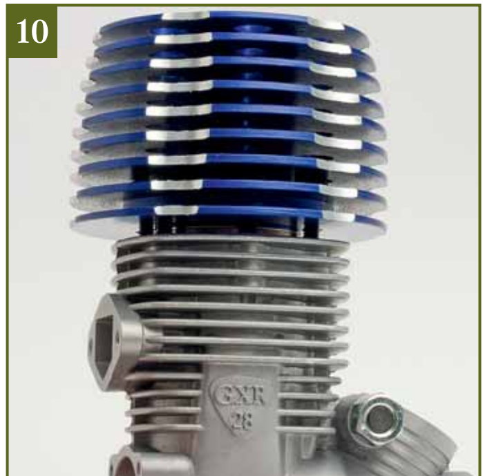
10 Nach dem Anziehen der Schrauben müssen die Rippen an Kurbelgehäuse und Zylinderkopf parallel zueinander ausgerichtet sein. Ist das nicht der Fall, lösen Sie die Schrauben und wiederholen die Arbeitsschritte 4 bis 9.
