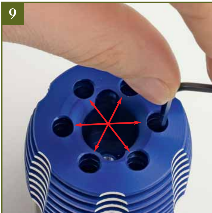
9 Um Materialverspannungen zu vermeiden, müssen die Schrauben über Kreuz fest angezogen werden (vgl. rote Pfeile). Nur so ist sichergestellt, dass der Brennraum absolut luftdicht verschlossen wird.
