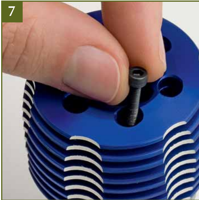
7 Im Anschluss positionieren Sie die verbleibenden fünf 3-mm-Inbusschrauben in den anderen freien Bohrungen des Zylinderkopfs. Die mittlere Bohrung bleibt frei. Sie nimmt später die Glühkerze auf.
