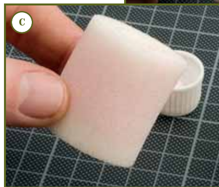
Rechts: Wenn der Luftfiltereinsatz nach dem Kneten eine gleichmäßige hellrosa Färbung aufweist, hat sich das Luftfilteröl optimal im Schaumstoff verteilt (c). Dank des Öls kann der Filter noch mehr Staub- und Schmutzpartikel aus der Luft binden.
