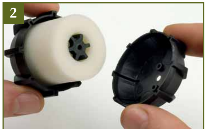
2 Setzen Sie das Oberteil des Filters auf das frei liegende Ende des Filtereinsatzes. Richten Sie es so aus, dass die Nasen an der Außenseite über denen des Unterteils zu liegen kommen.
