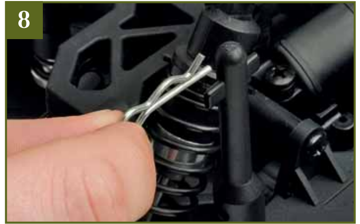
8 Die abgerundeten Enden der Stützen ragen bei aufgesetzter Karosserie aus der Lexan-Hülle heraus. Bohrungen in Querrichtung nehmen die vier Karosserieklammern auf. Verstauen Sie diese einstweilen in Ihrer Teilebox.
