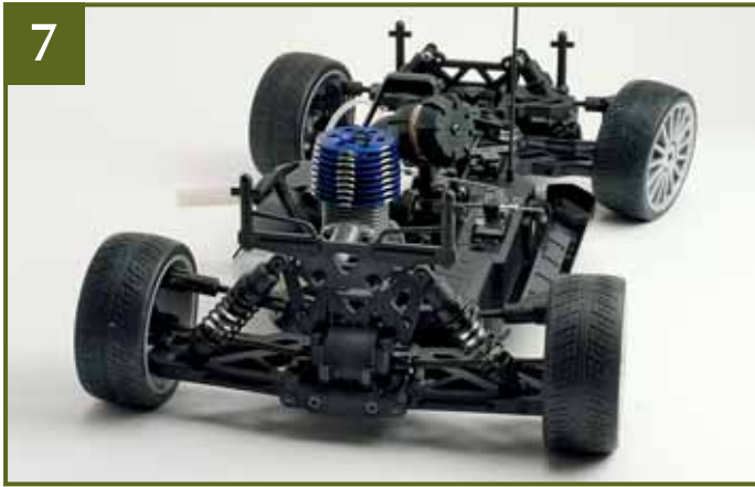
7 Das Chassis nach Abschluss dieses Montageabschnitts in der Heckansicht. Die vier Karosseriestützen überragen die vorderen und hinteren Aufbauten des Chassis um etwa einen Zentimeter.
